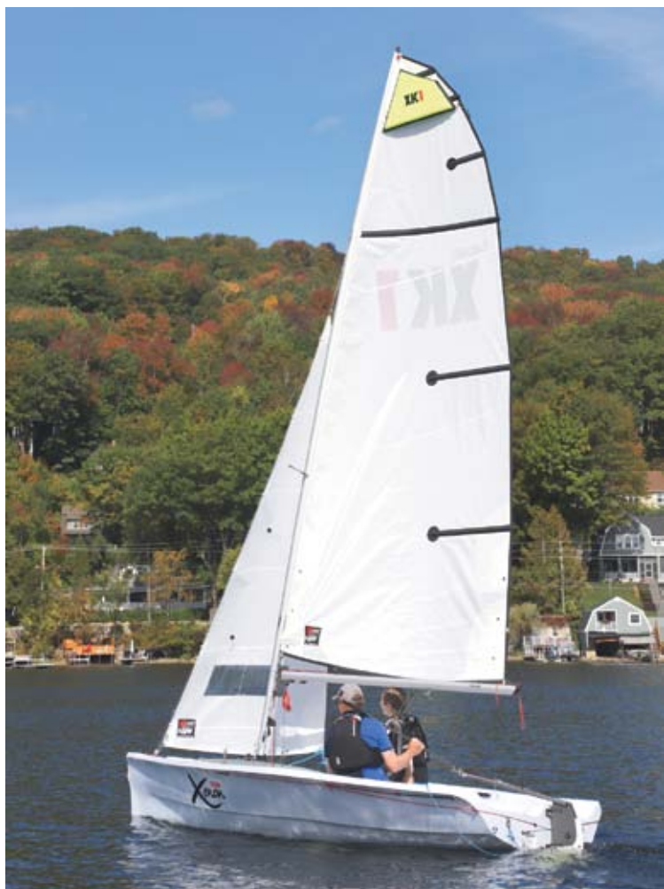
Le XK1 a une surface de voile réduite pour faciliter sa prise en main par des équipages novices.
