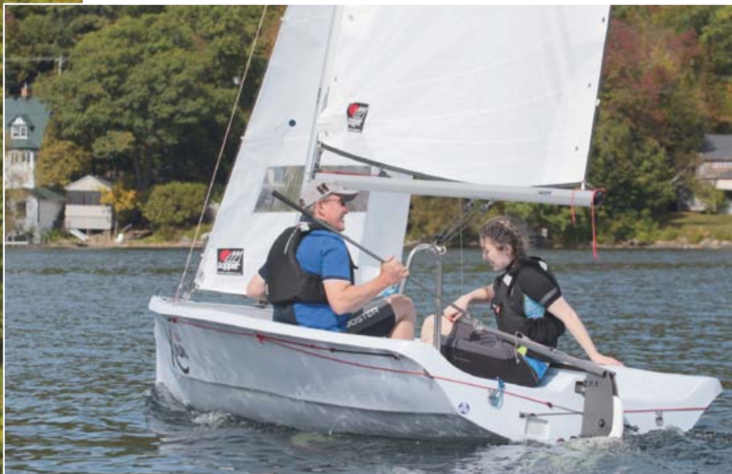
On aperçoit clairement le bouchain vif à la flottaison et les formes évasées de la coque jusqu'au livet. Des formes en V qui favorisent le couple de rappel.
